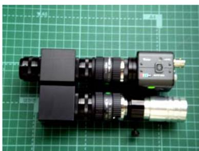
高輝度LEDを用いた落射照明型
